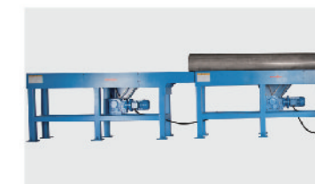
管道进料输送系统 Front pipe conveyor
