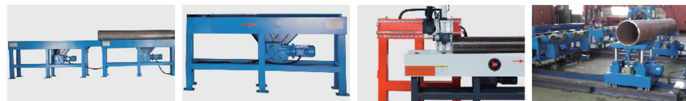
管道进料输送系统 Front pipe conveyer
